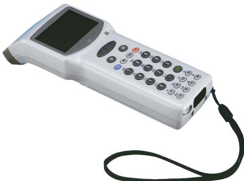
Der PHL 2700 ist ein leistungsfähiges mobiles Laserterminal mit 8 MB Datenspeicher für verschiedenste Anwendungen. Mit dem integrierten Laserscanner können Barcodes durch Kontakt- und Distanzlesen erfasst werden.
