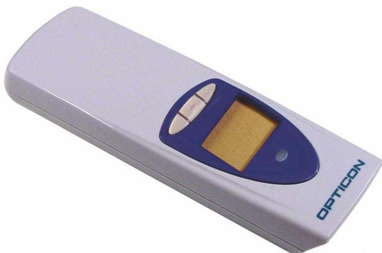
Der OPL-9723 ist ein kleiner mobiler Laserscanner mit drei frei definierbaren Tasten, grafikfähigem LCD-Display, eingebauter Echtzeituhr und Datenspeicher (512 kB Flash ROM und 512 kB RAM). Die einfache Bedienerschnittstelle ermöglicht fehlerfreies Arbeiten.
