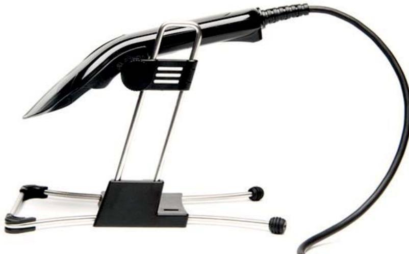
Der L-22X ist ein robuster 2D-CMOS-Imager zum Lesen aller gängiger 1D- und 2D-Codes. Neben der warmweißen LED Lichtquelle verfügt der Scanner über eine helle, grüne LED-Hilfsbeleuchtung, die ein einfaches Anvisieren des Codes unterstützt.
