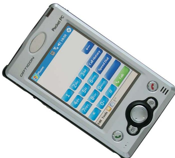
Der PHL 5300 ist ein Pocket-PC-basierendes PDA, das neben einem Barcode-Laserscanner sowohl mit einem GSM-Telefon (GSM/GPRS) als auch mit Bluetooth ausgestattet ist. Damit eröffnet das Gerät eine breite Palette von möglichen mobilen Einsatzbereichen.
