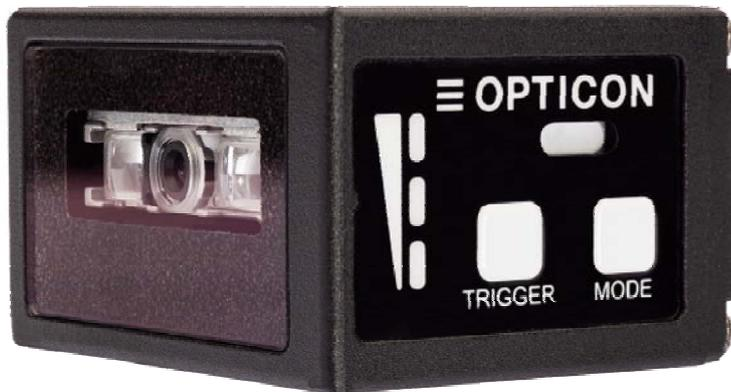
Der NLV 5201 ist ein 2D-Code Leser mit einer integrierten hochauflösenden CMOS-Kamera (640x480 Bildpunkte). Mit dieser Kamera ist es möglich, sowohl Strichcodes als auch 2D-Codes unabhängig von der Lage omnidirektional zu lesen. Ein besonderes Feature ist, dass die Codes mit hoher Geschwindigkeit (100 Frames/Sekunde) dieser Optik erfasst werden können.
