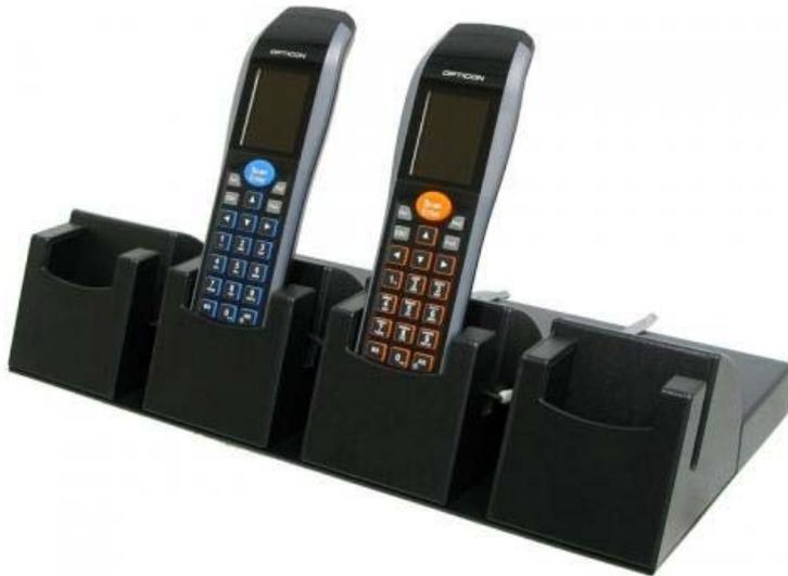
Die Dockingstation CLK-4 für die mobilen Datensammler OPH-3000 ist ein 6-fach Multicradle mit Lade- und Übertragungsfunktion für bis zu 4 Scanner an einem USB-Anschluss.
